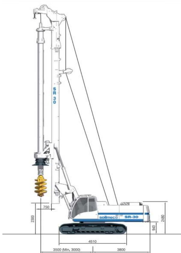
Буровая установка Soilmec SR-30 легко транспортируется на трале по дорогам общего пользования и разворачивается в рабочее положение всего за 10-15 минут. Благодаря наличию мощного силового агрегата и современной электроники, данная техника является очень универсальной. Она одинаково хорошо подходит как для струйной цементации методом «стена в грунте», так и для установки буронабивных свай различного типа.
